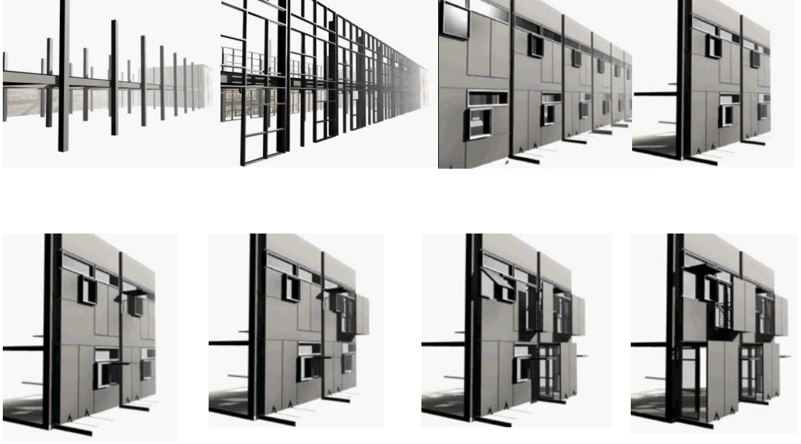
Şekil 5.2. Cephenin, ışığı içeri almak için ya da doğal iklimlendirmeyi sağlamak için kendini değiştirmesi .
